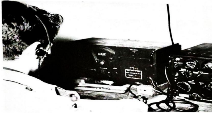
نوع من محطات الراديو الثابتة (مركز قيادة الشبكة) : جهاز إرسال ART 13 وجهاز استقبال BC 610.
