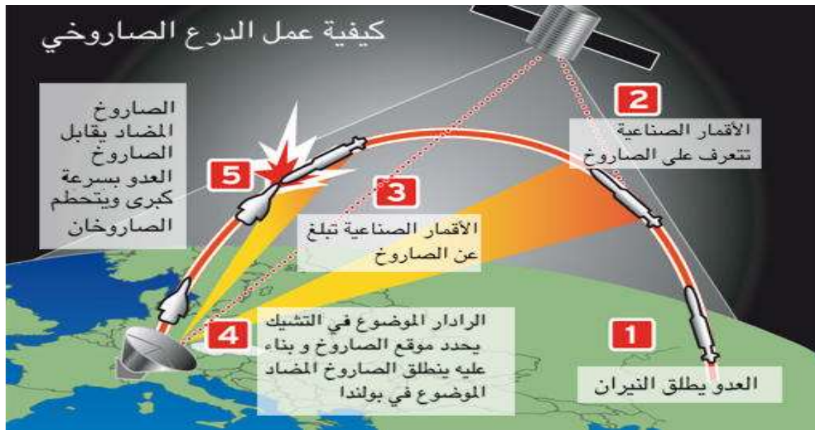
شكل 12: خطوات عمل الدرع الصاروخي عند استشعار التهديد.
